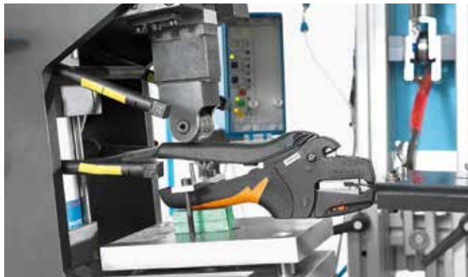
A stripax® tartósságának tesztelése a Weidmüller laboratóriumában
